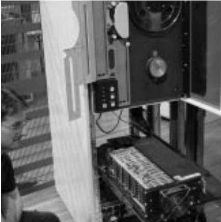
Ein Hackertraum wird wahr. Unten im Gehäuse die PDP11, die das oben eingebaute Halb Zoll-Bandlaufwerk steuert. Die luftdruckgedämpfte Führung des Bandes ist links oben zu erkennen. Die PDP11 bootete klaglos und zog mehrfach erfolgreich unter erheblicher Geräusentwicklung ein Band ein.
